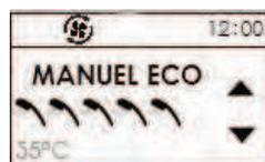
Ce mode de fonctionnement permet d'assurer des chauffes en Pompe à Chaleur seule dans les plages de fonctionnement choisies (créneau heures creuses ou programmation). Ce mode permet aussi de régler le nombre de douches.
